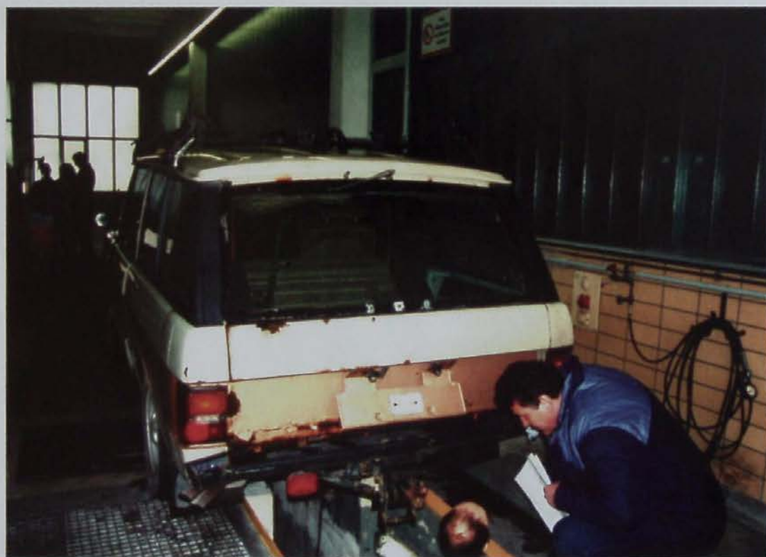
Sachverständige der Landesprüfanstalt bei einem völlig durchgerosteten Range-Rover.
