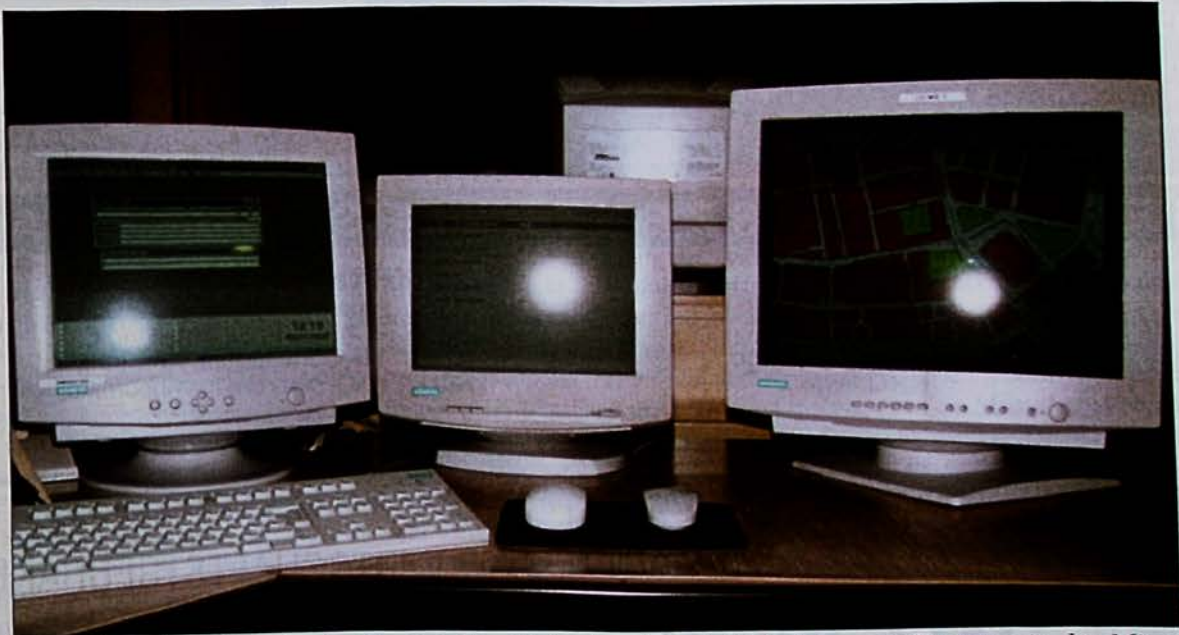
Notrufannahmepplatz in der Funkstelle. Links der Arbeitsbildschirm mit Tastatur; in der Mitte der Bildschirm für die Anzeige der Telefonnummer und des Namens und Anschrift des Anrufers - rechts der Grafikbildschirm mit automatischer Anzeige des Einsatzortes,
